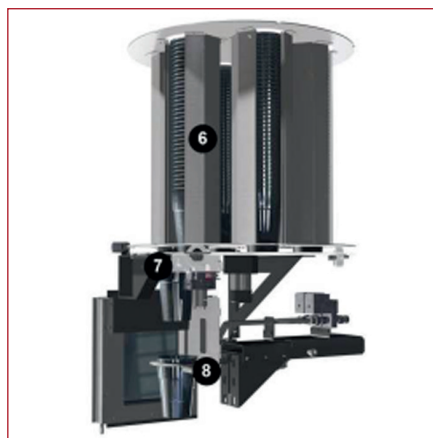
Abbildung 2 Detailansicht des Becherfüllers und Ausgabegeräts
